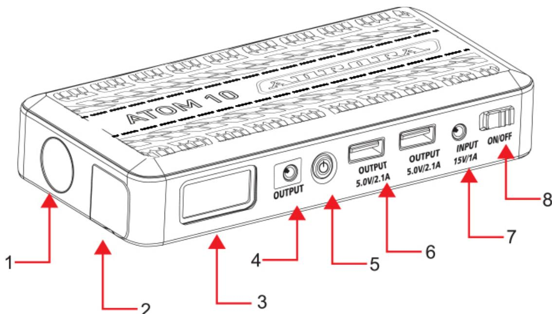
1 – Фонарь; 2 – Пусковой разъем; 3 – Светодиодный дисплей; 4 – Выход 12/16/19В 3.5А; 5 – Кнопка включения; 6 – Выход 5В 2.1А; 7 Вход 15В 1А; 8 - Кнопка вкл/выкл.
