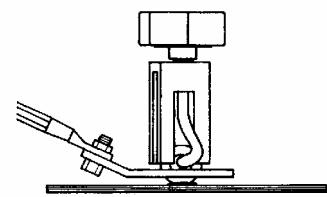
**Одновременная точечная сварка. И выравнивание при помощи шайбы специальной формы.**
