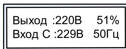
**Рисунок 6б.** ЖК-дисплей в режиме основного экрана (отображение выходных параметров и входного напряжения фазы С)
