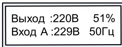
**Рисунок 6а.** ЖК-дисплей в режиме основного экрана
