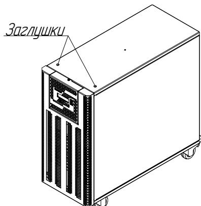
**Рисунок 13.** Размещение пластмассовых заглушек на стабилизаторах IS3115RT и IS3120RT
