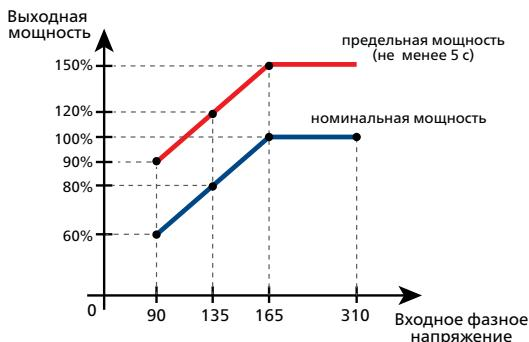
Рисунок 11. Зависимость выходной мощности от входного напряжения
