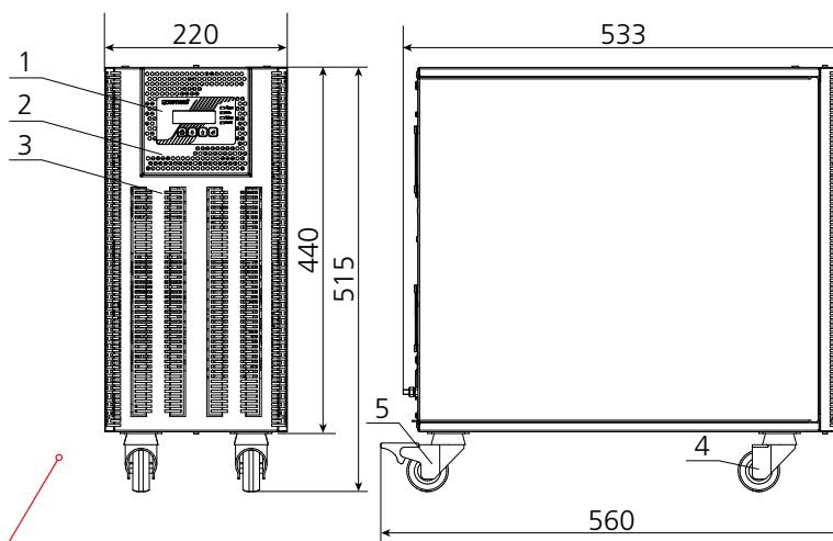
**Рисунок 2б.** Габаритные размеры и компоненты передней панели стабилизаторов Штиль IS3110RT и IS3120RT (вертикальная напольная установка)
