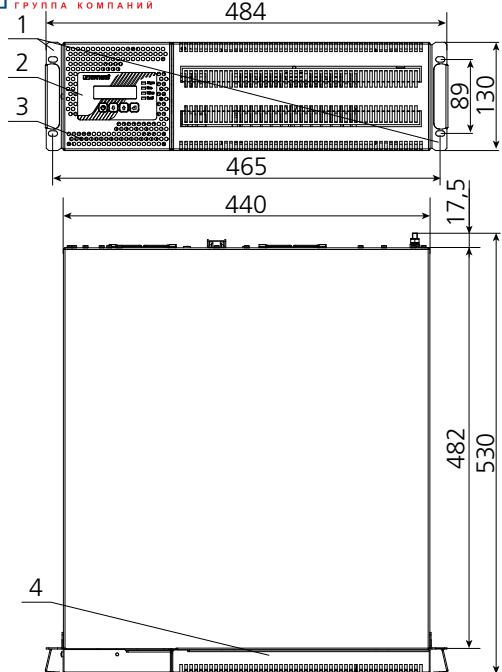
**Рисунок 2в.** Габаритные размеры и компоненты передней панели стабилизатора Штиль IS3110RT (горизонтальная установка в стойку)
