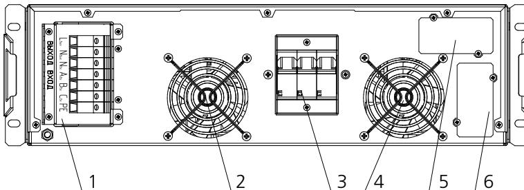
**Рисунок За.** Компоненты задней панели стабилизатора Штиль IS3110RT
