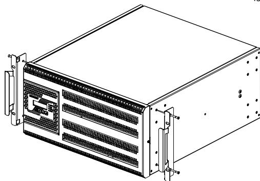
**Рисунок 14.** Установка кронштейнов для горизонтального крепления к стабилизаторам IS3115RT и IS3120RT<sup>1</sup>
