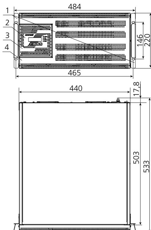
**Рисунок 2г.** Габаритные размеры и компоненты передней панели стабилизаторов Штиль IS3115RT и IS3120RT (горизонтальная установка в стойку)
