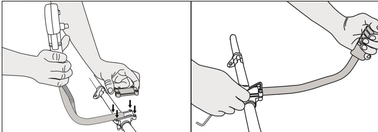
Рис. 3 Установка рукояток
