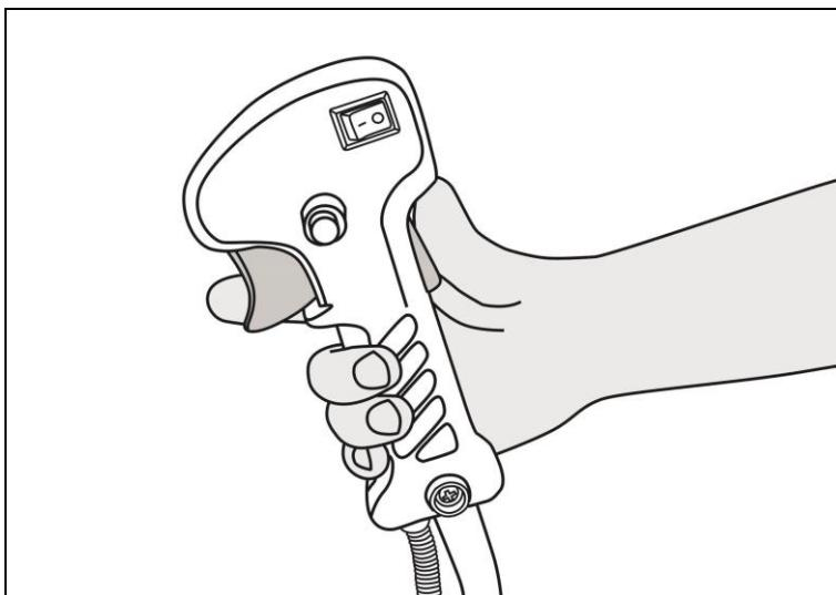
Рис. 13 Включение триммера
