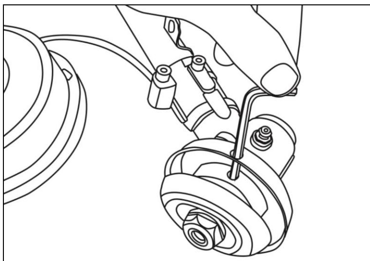
Рис. 6 Фиксация ступицы вала.
