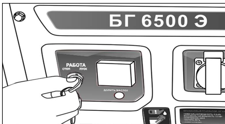
Рис. 17. Запуск двигателя электростартером
